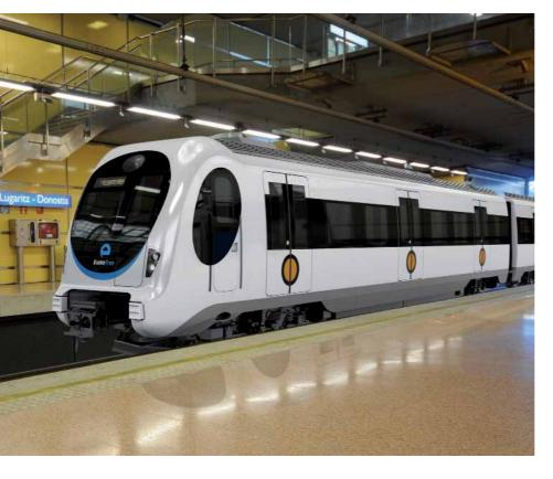
motores de tracción, dos por coche motor, con una potencia de 180 kW, para un total por tren de 1.440.
