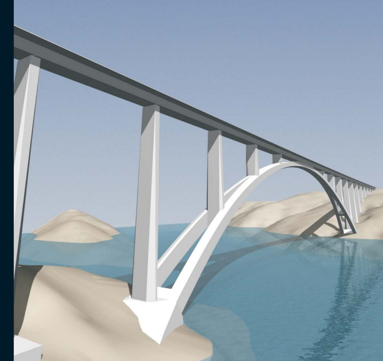
FASE 11: Ejecución de vanos de acceso de tablero mediante autocimbra. Ejecución de vano sobre clave del arco mediante cimbra cuajada apoyada en el propio arco.
