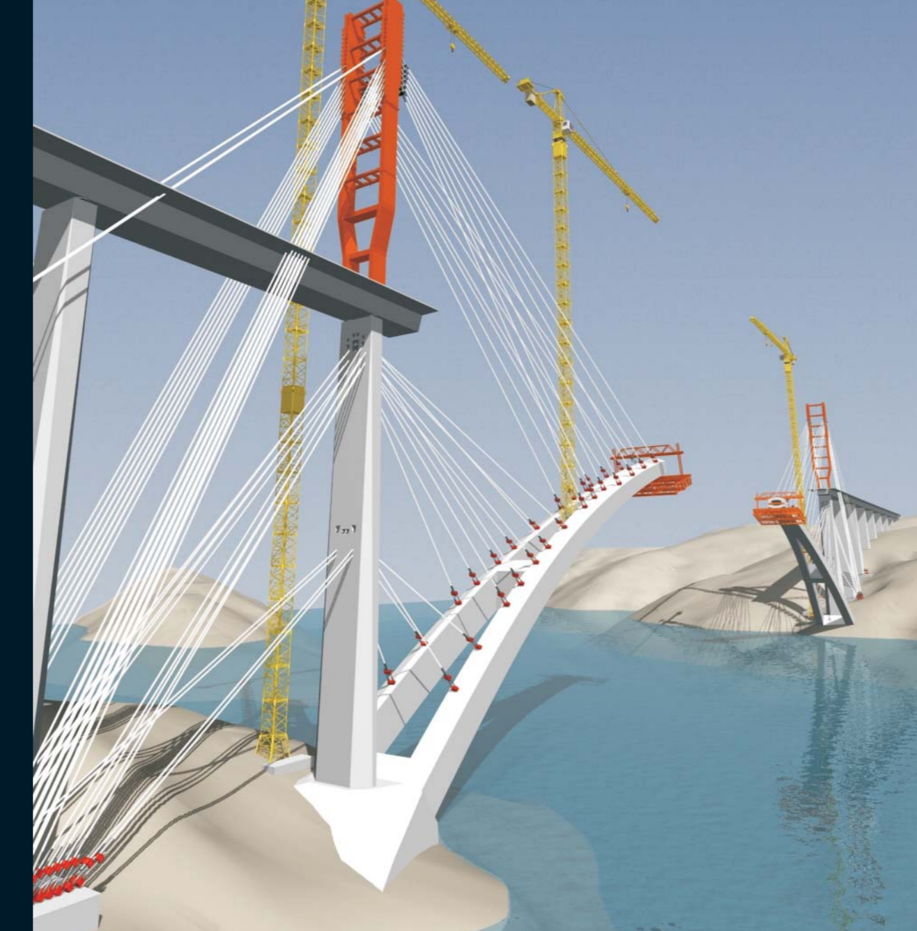
FASE 11: Ejecución de vanos de acceso de tablero mediante autocimbra. Ejecución de vano sobre clave del arco mediante cimbra cuajada apoyada en el propio arco.
