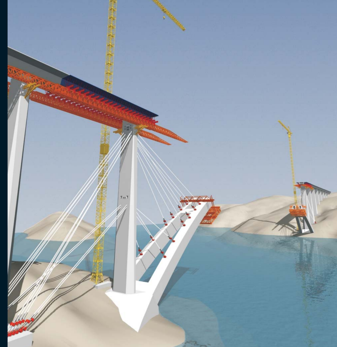
FASE 10: Desmontaje de las torres grúa sobre el arco y las grúas principales. Ejecución de vanos de acceso de tablero mediante autocimbra.
