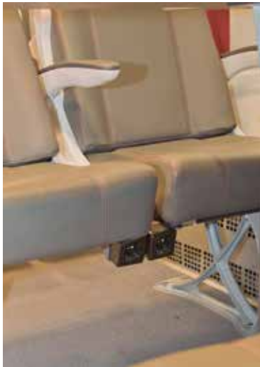
Tomas individuales de corriente en las butacas.
