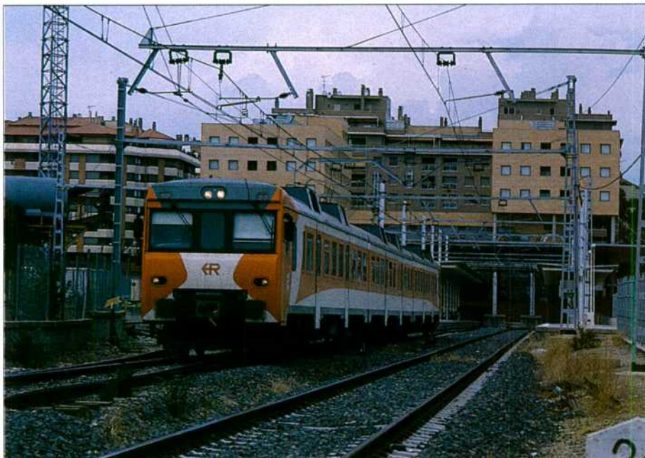
La nueva estación de Huesca tiene ahora la catenaria sin servicio.
