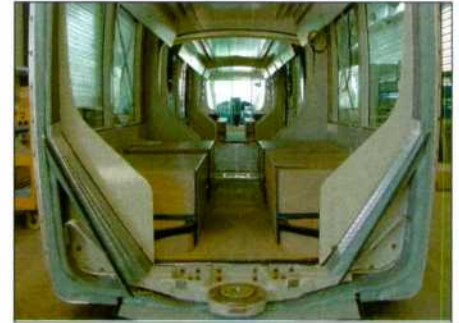
Zona de enganche entre módulos..
