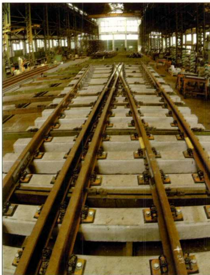
Se ha desarrollado una traviesa monobloque, válida para dos anchos.
