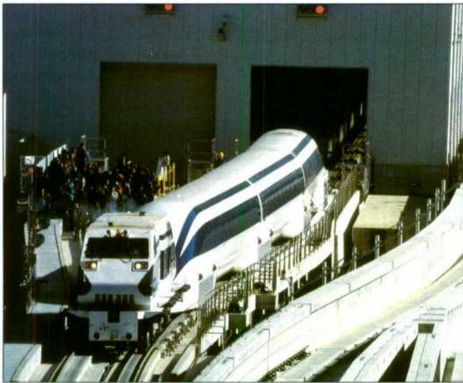
Tren MLX 01 arrastrado por una locomotora de maniobras.
