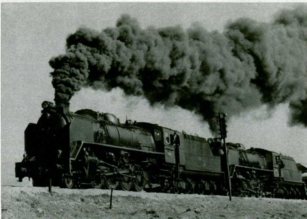
Una doble tracción de "Mikados" imprime una vigorosa marcha a un tren de potasas entre Iurzun y Alsasua.
