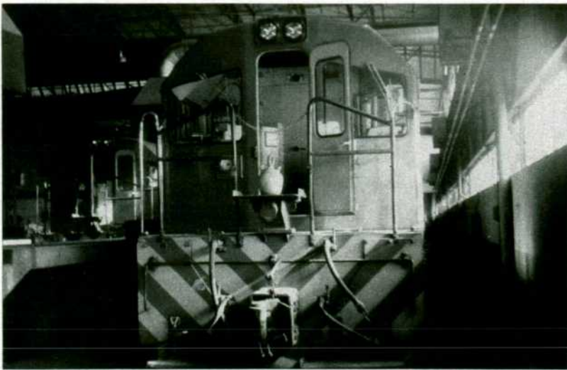
F. C. Tajuña: moderna locomotora Diesel-eléctrica (1.200 CV.) en los talleres de Vicálvaro.
