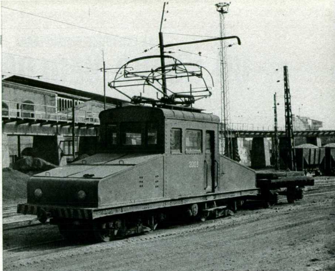
Locomotora eléctrica número 2003, de 320 HP., de bogies, construida por Macosa (Cenemesa) en 1953.
