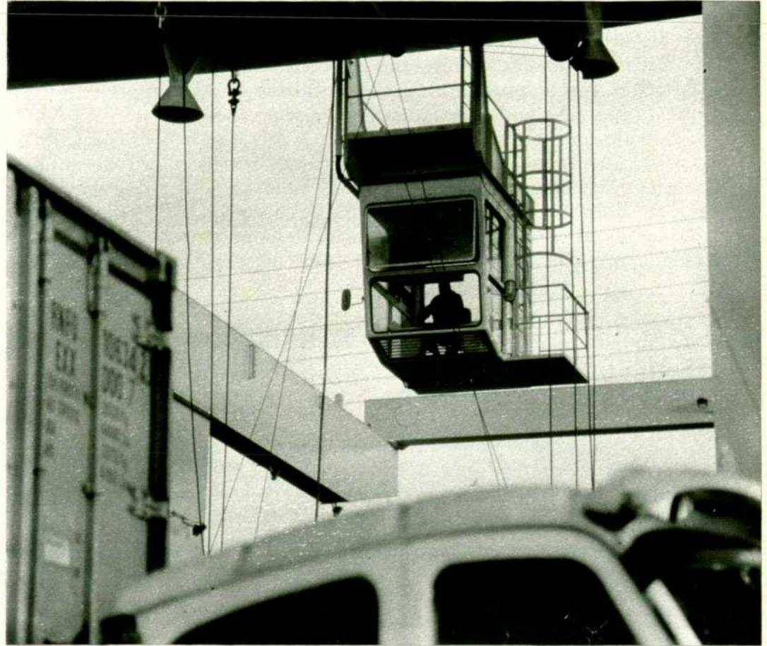
Cabina de mando desde la cual se dirigen las operaciones de la grúa-pórtico en la terminal de Contenedores. (Foto: MAN.)
