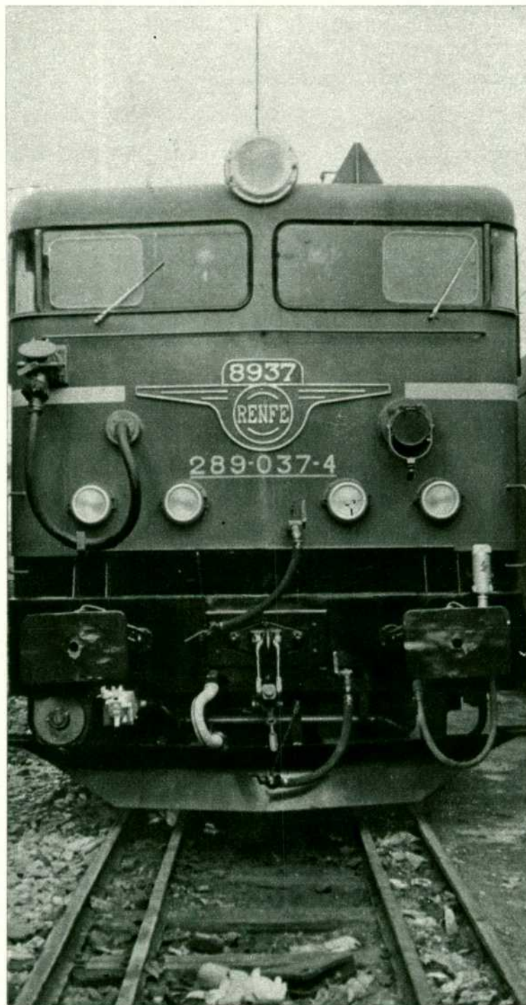
Testero de la locomotora 289-037, dotada de freno dual. En la parte inferior se encuentran la TGFV y la TGFA.
