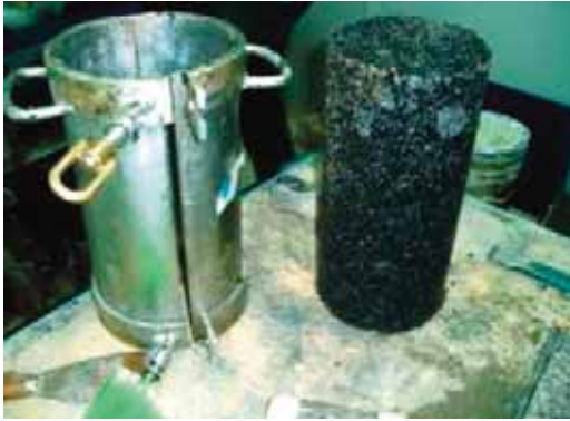
Figuras 4 y 5. Ejemplo de probetas y ensayo a compresión simple.
