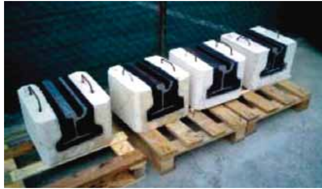
Figuras 6 Y 7 : Vista de la sección del sistema M.L.G; Vista general de los prototipos una vez hormigonado.
