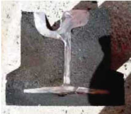
Figuras 6 Y 7 : Vista de la sección del sistema M.L.G; Vista general de los prototipos una vez hormigonado.
