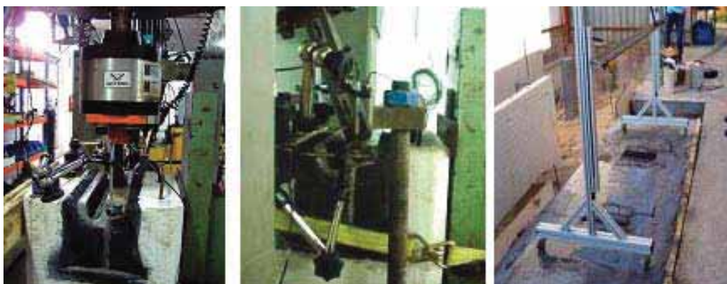
Figuras 8 ,9 y 10: Vista general de la disposición del prototipo en el ensayo de carga vertical estática.; Vista general del prototipo en el ensayo de carga estática angular (22°); Disposición del ensayo de aislamiento eléctrico.
