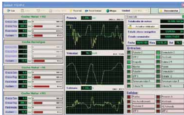
Fig. 4: Monitorización de los consumos de las unidades de tren
