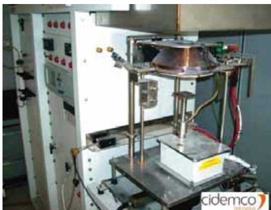
Fig. 1a-b. Cono calorimétrico (ISO 5660).
