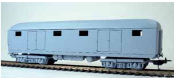
El aspecto mejora notablemente tras la aplicación de la imprimación.
