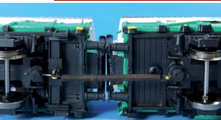
Sistema de enganche semipermanente por medio de un muelle.
