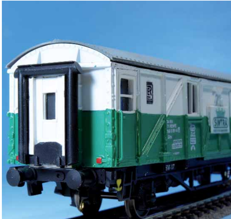
Testero equipado de puerta de intercomunicación.
