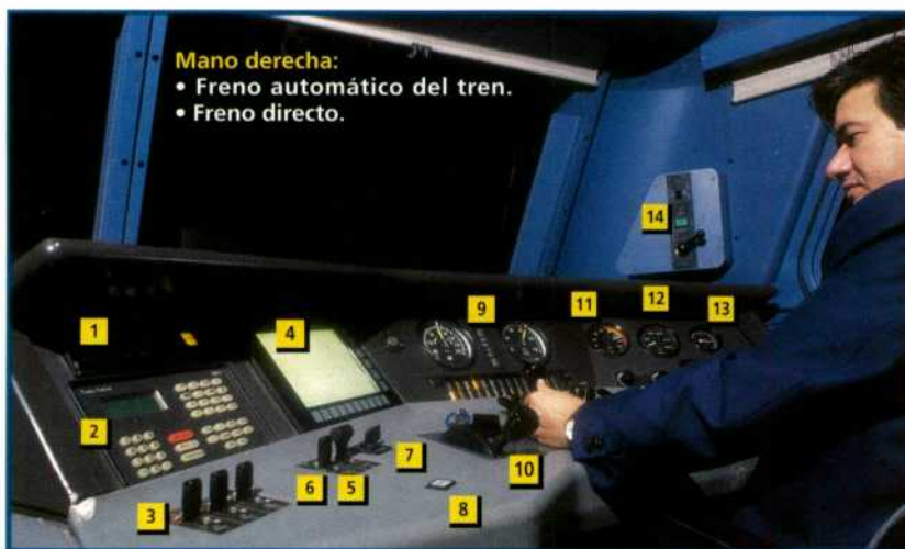
1. Panel ASFA. 2. Panel TrenTierra. 3. Interruptor LZB. 4. Monitor de datos de locomotora. 5. Interruptor pantógrafos. 6. Disyuntor principal. 7. Calefacción del tren. 8. Reconocimiento de ASFA 9. AICC. 10. Manipulador de tracción y freno eléctrico. 11. Voltímetro de línea. 12. Amperímetro de línea. 13. Manómetro doble. 14. Manipulador tracción maniobra.
