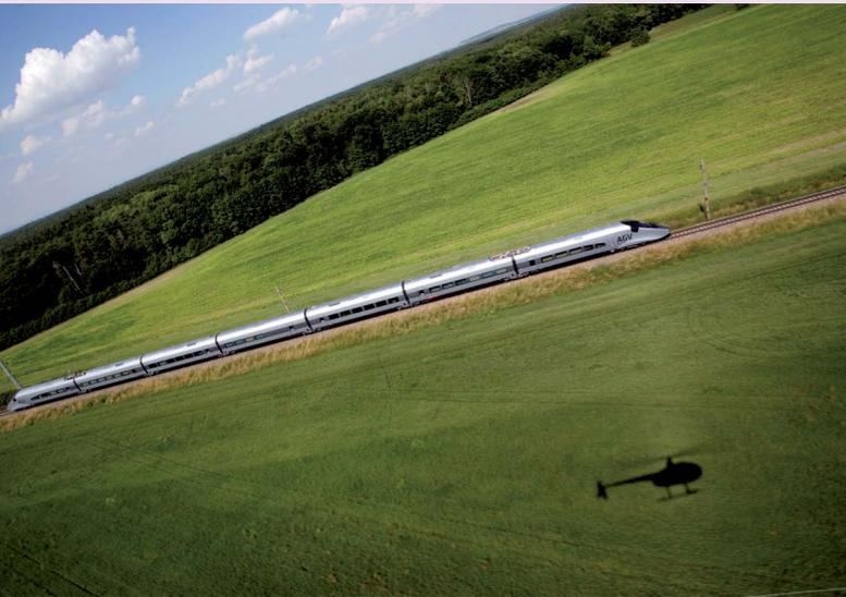
La Automotriz Gran Velocidad (AGV) de Alstom es el tren de Alstom capaz para más de cuatrocientos viajeros y con velocidad máxima de 360 km/h, que combina la arquitectura de los trenes articulados con bogie compartido, con la motorización distribuida.
