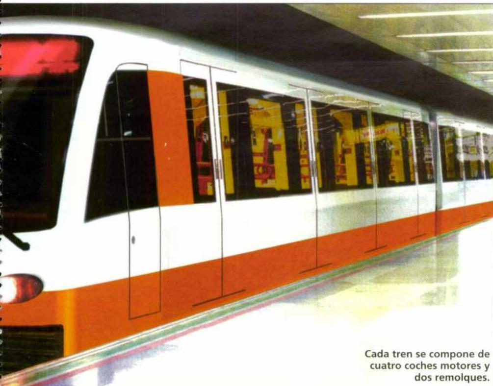
Cada tren se compone de cuatro coches motores y dos remolques.
