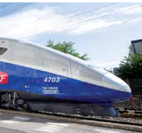
Los TGV Duplex de tercera generación entrarán en servicio a finales de año. Podrá circular bajo tensiones de 1.500, 15.000 y 25.000 voltios.
