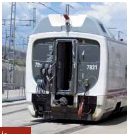
Coche extremo de la serie 130 que se retira para incorporar el furgón con los equipos de tracción diésel.
