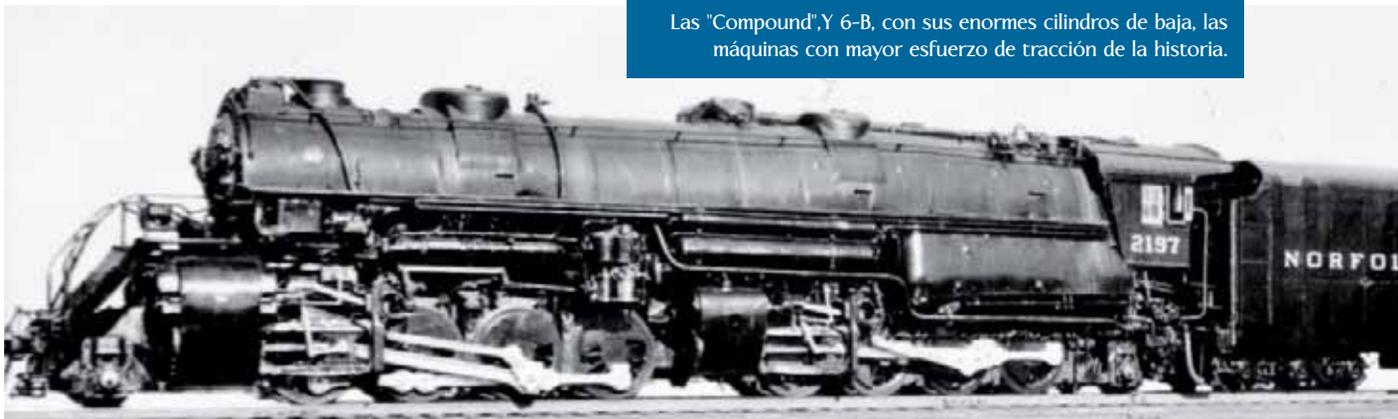
Las "Compound", Y 6-B, con sus enormes cilindros de baja, las máquinas con mayor esfuerzo de tracción de la historia.
