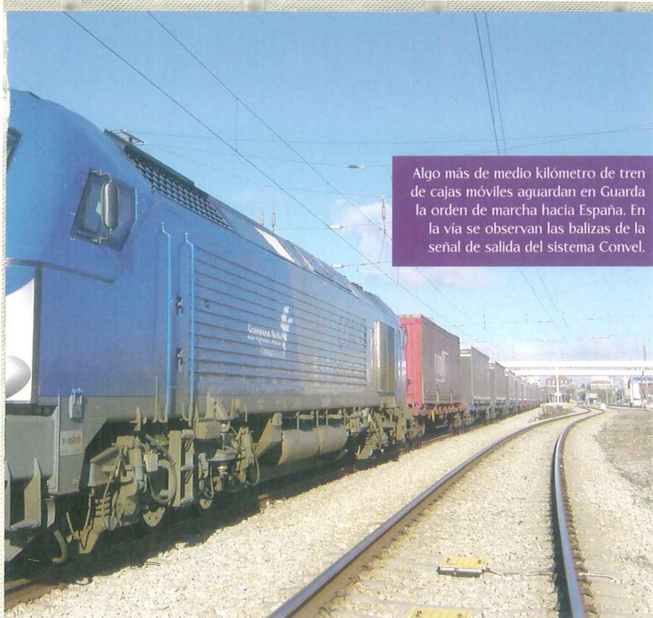
Algo más de medio kilómetro de tren de cajas móviles aguardan en Guarda la orden de marcha hacia España. En la vía se observan las balizas de la señal de salida del sistema Convel.
