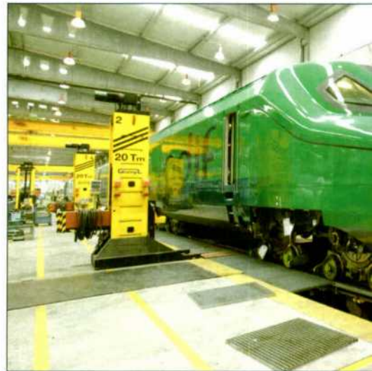
Tren auscultador de Adif para líneas de alta velocidad
