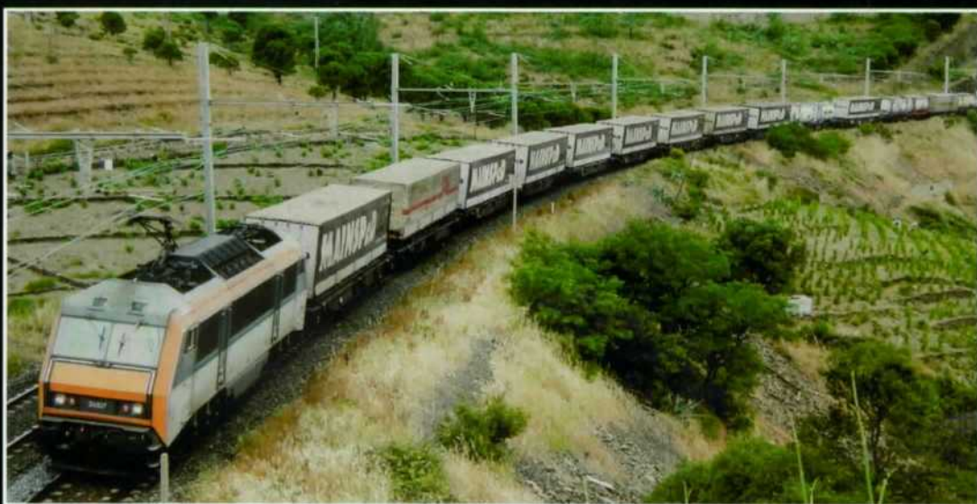
Locomotora BB 26000 arrastrando contenedores y cisternas en la línea de Cerbere. Imagen tomada en junio de 2004. Foto HÉCTOR GONZALO GARCÍA
