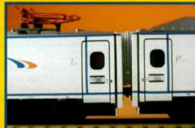
Al estar equipado con enganche corto y dispositivo cinemático, la unión entre coches resulta muy realista
