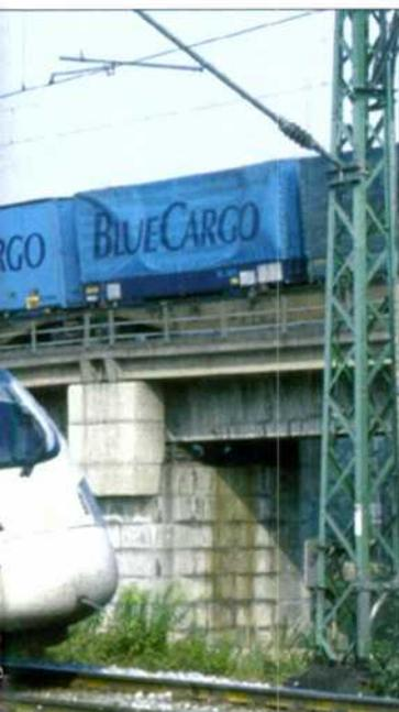
paquetería urgente. Las locomotoras poseen un peso por eje de 22,5 t y los vagones, de 16 t.
