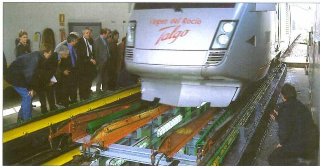
La cabeza tractora del Talgo XXI tiene bogies de ancho variable.
