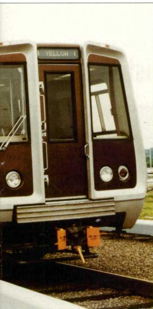
cada coche que es de 107 pasajeros de pie y 68 sentados. La alimentación se realiza por un tercer carril con una tensión nominal de 700 V en corriente continua, para una tensión de los equipos de 230 V en corriente alterna trifásica, a 60 Hz, y una tensión de batería de 37,5 V en corriente continua.
