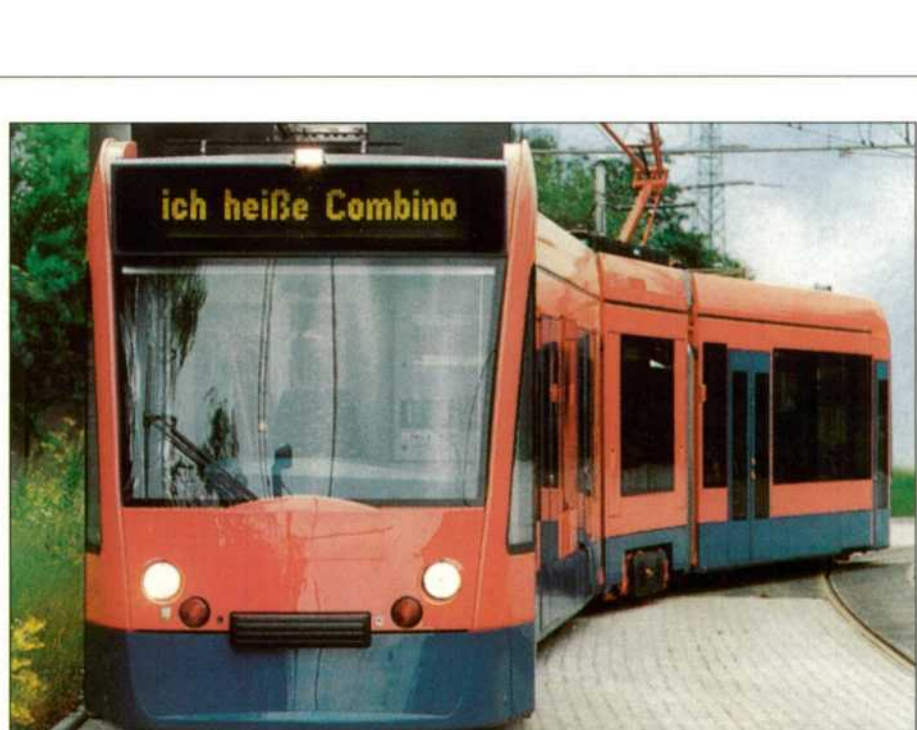
Tranvía Combino de construcción modular.
