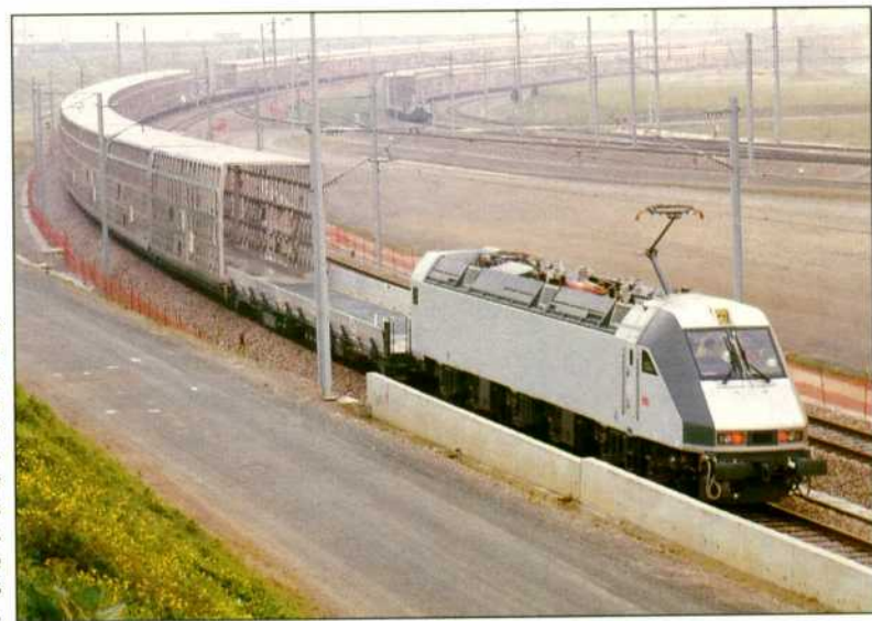
Las locomotoras de las lanzaderas se han diseñado para circular por las cerradas curvas de las terminales.
