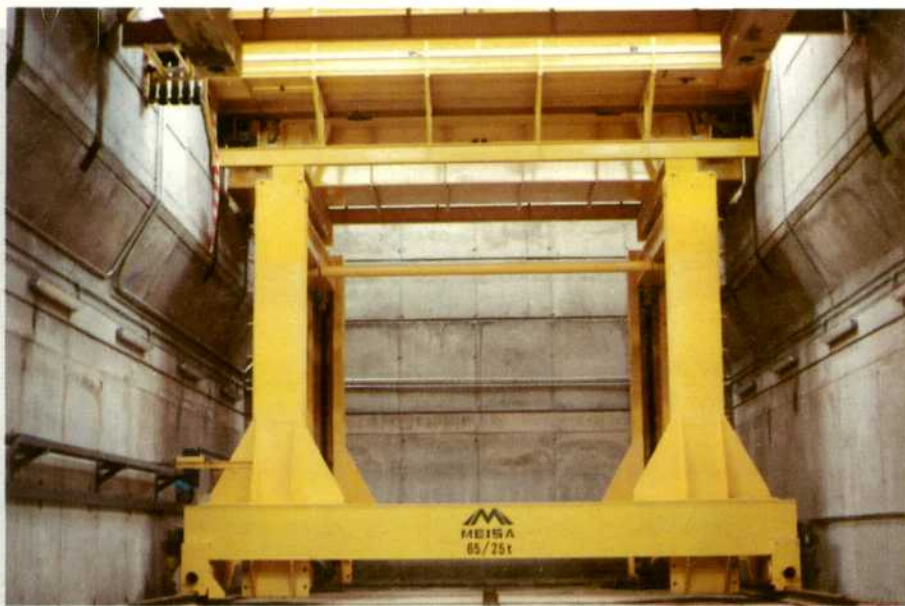
Baja bogies de 65/25 TM. instalado en RENFE La Sagra
