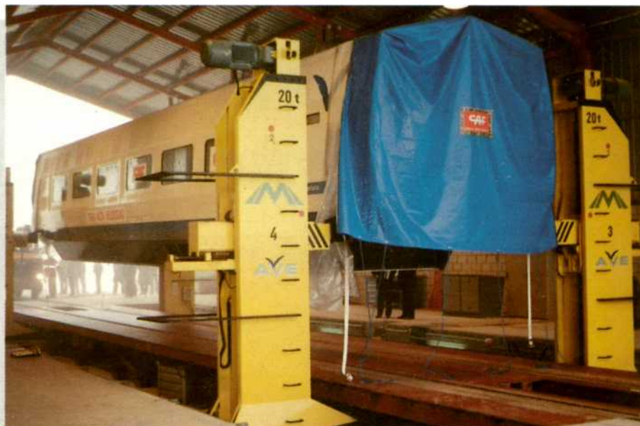
Conjunto de gatos de 80 TM. con autómata programable y uñas móviles con carga
