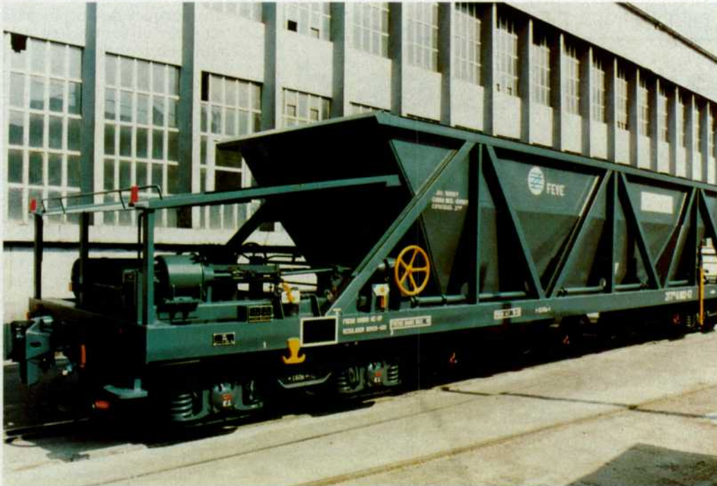
Prototipo de vagón tolva fabricado para FEVE.
