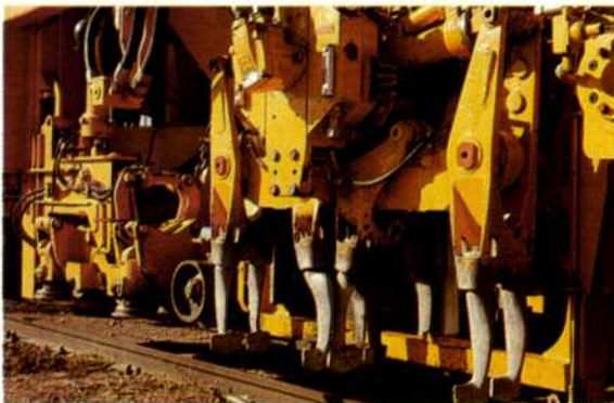
Las actuales bateadoras poseen grupos de bateo cíclico, asíncronos y con oscilación direccional.
