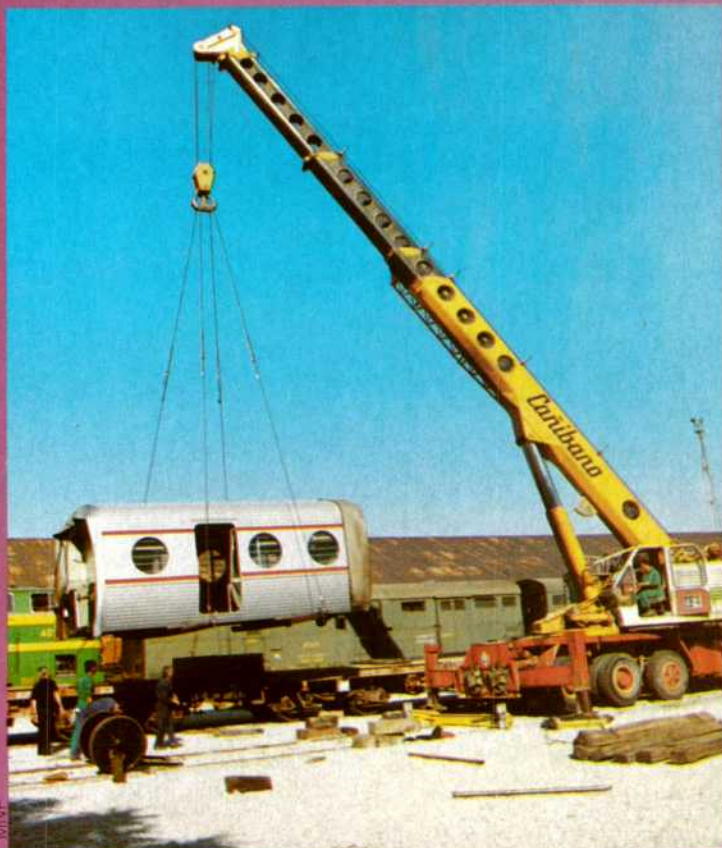
Los módulos del Talgo, que se desmontaron en el MNF, se elevaron con grúas y se colocaron en plataformas.
