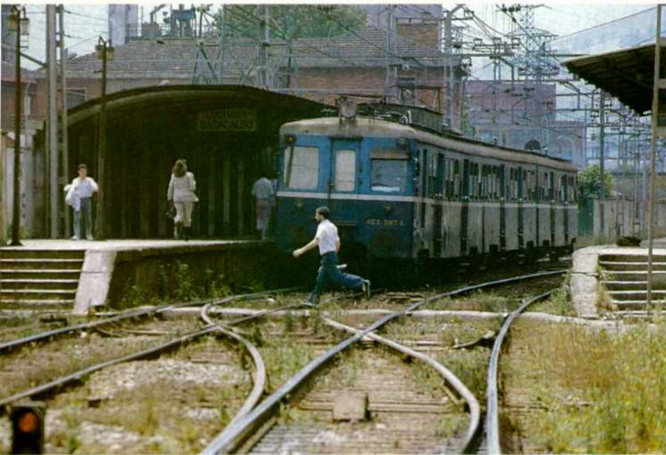
Automotores serie 301 al 328, adquiridas por la compañía del norte entre 1928 y 1930 para prestar servicio en sus líneas electrificadas de Cataluña y de Alsasua a Irún. Renfe trasladó después algunas a la de Bilbao-Santurce su numeración U.I.C. es la 433.
