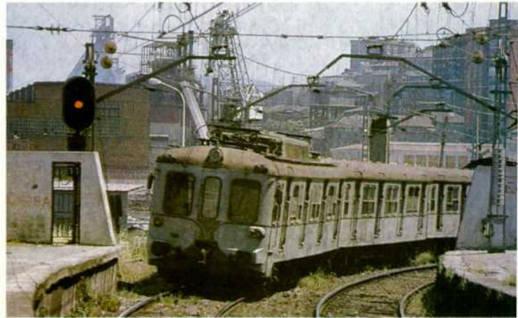
Automotores serie 401-411 adquiridos por la Renfe para las líneas Bilbao-Santurce y San Julián de Musques. Inicialmente estaban formadas por 11 coches motores, 17 remolques intermedios y 17 remolques con cabina. Su numeración U.I.C. fue 434.
