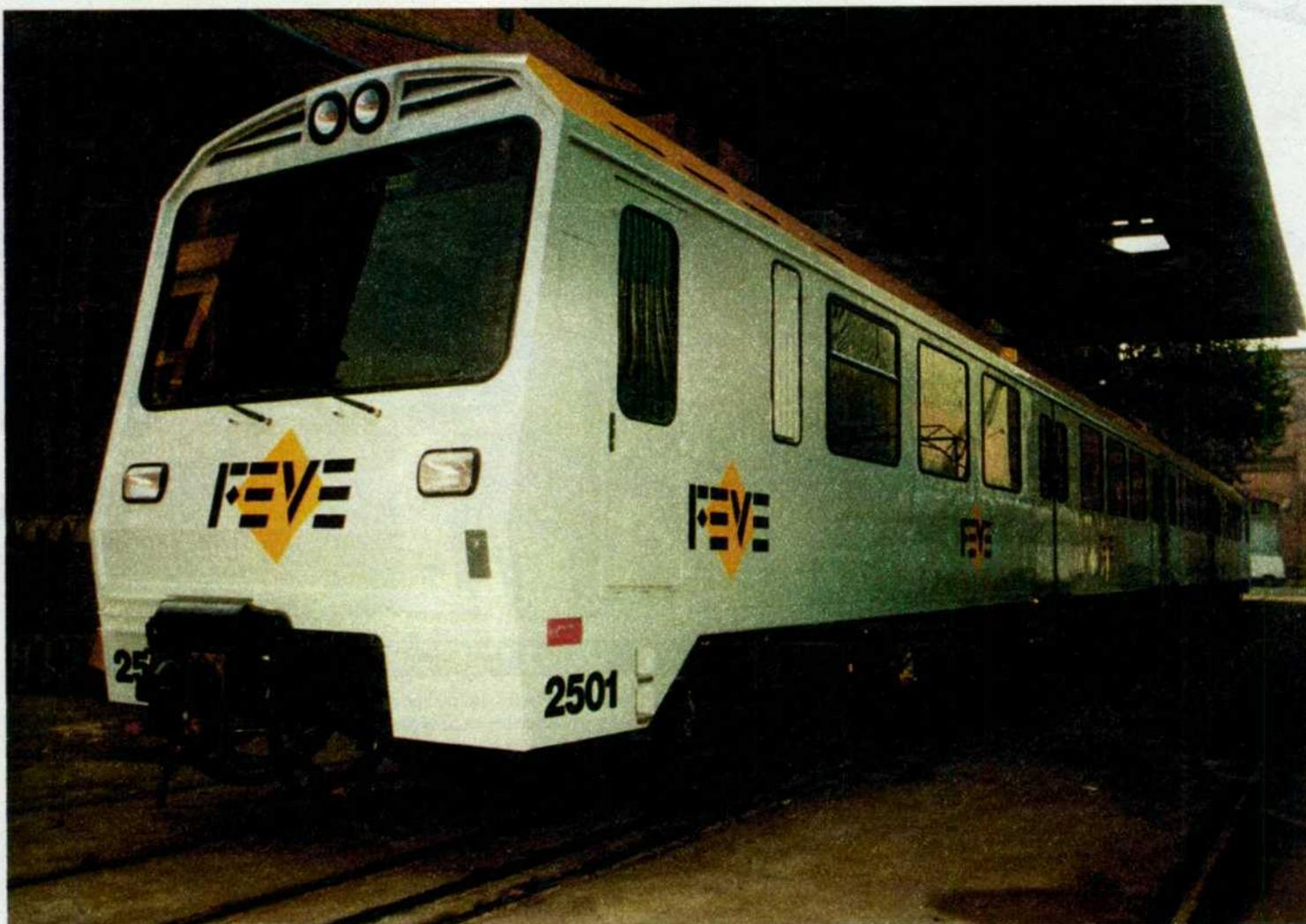
tico. Las ventanas fijas, con unas dimensiones aproximadas de 1.215 x 910 milímetros, poseen vidrios de seguridad exterior de efectos especulares y fijados sobre perfil de goma. La unidad cuenta con dos departamentos de viajeros, con asientos laterales a ambos lados de la caja, separados por un pasillo central. El número de plazas sentadas es de 80 por unidad de tren, con una densidad prevista de seis viajeros por metro cuadrado.
