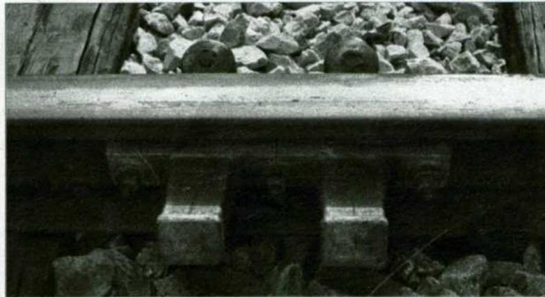
Detector electrónico direccional, formado por dos pedales electromagnéticos.
