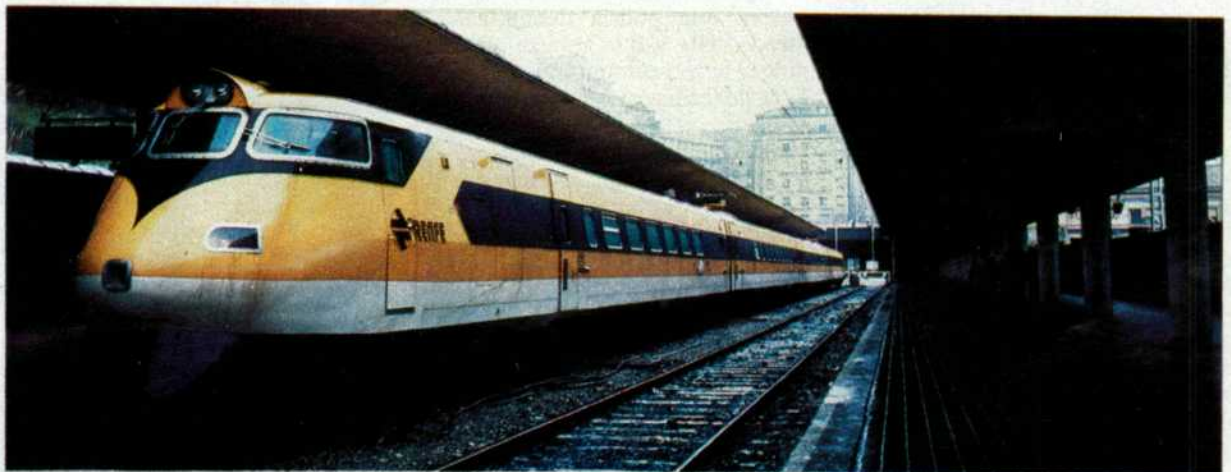
El electrotrén basculante, único vehículo con tracción eléctrica capaz de circular a más de 160 km/h. en la actualidad.
