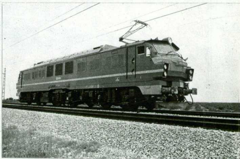
Locomotora 251 primera serie, dotada en su totalidad con equipo chopper.
