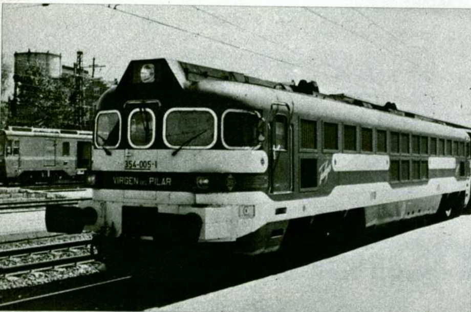
Locomotora Diesel 354 del Talgo Pendular concebidas para circular a 180 km/h.
