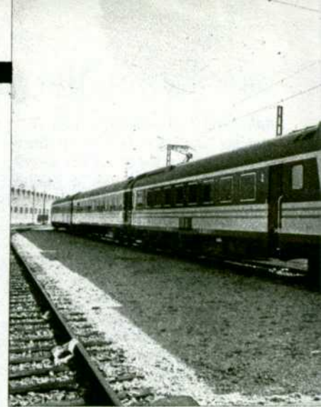
Electrotren 444-500, de los que ya hay en servicio seis y otros cinco en construcción. Serán completados con otros 20 recién contratados.
