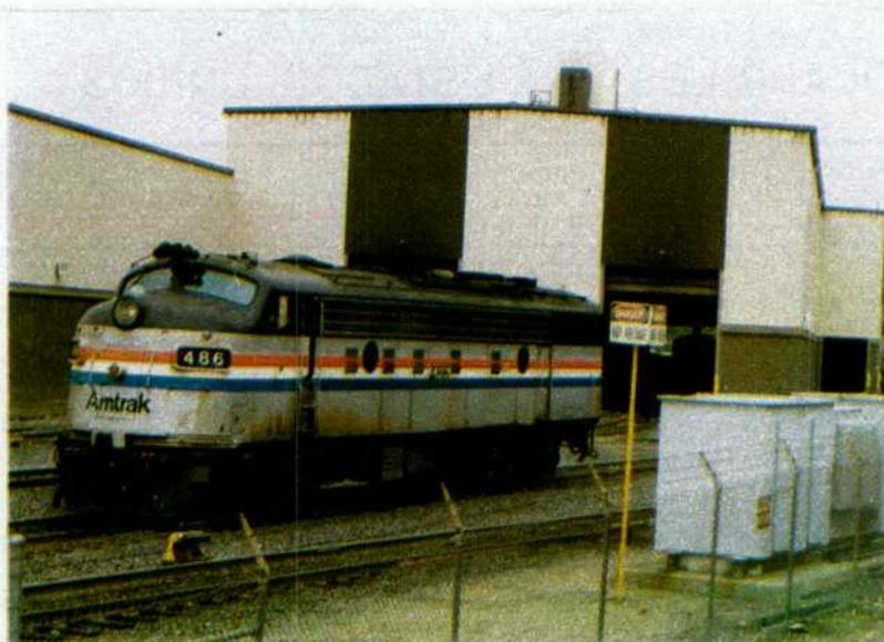
Las locomotoras Diesel FL-9 de General Motors tienen patines laterales para poder captar la energía eléctrica del tercer carril y poder entrar así en el túnel del Grand Central Terminal de Nueva York con el motor Diesel parado.
