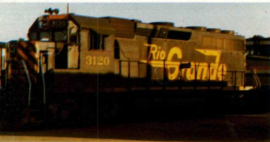
Locomotora Diesel del modelo GP-40-2, de General Motors. Tiene 3.000 CV. y es tipo Bo Bo. Perteneció al ferrocarril Rio Grande.
