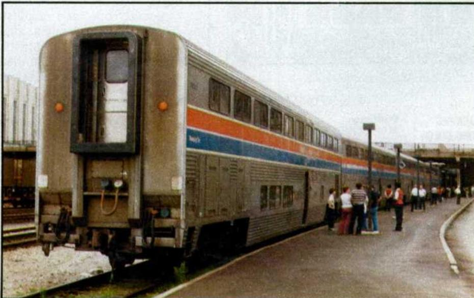
*En los coches Superliner, la intercomunicación entre coches se efectúa por el piso superior. La estación de Omaha, junto al río Missouri, punto de origen del Union Pacific.*
