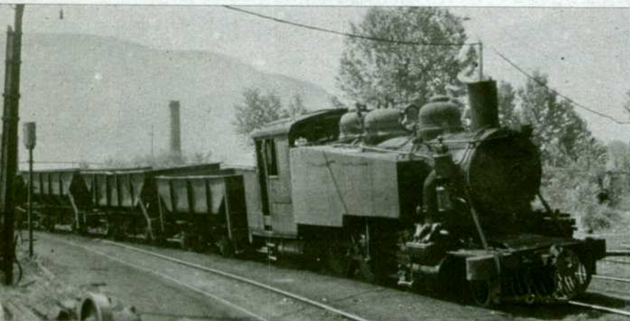
La última Baldwin en funcionamiento en el P. V. es la núm. 2, «Conde de Gaitanés», tipo 1-3-1 T. Aquí, haciendo maniobras en el lavadero de Ponferrada.
