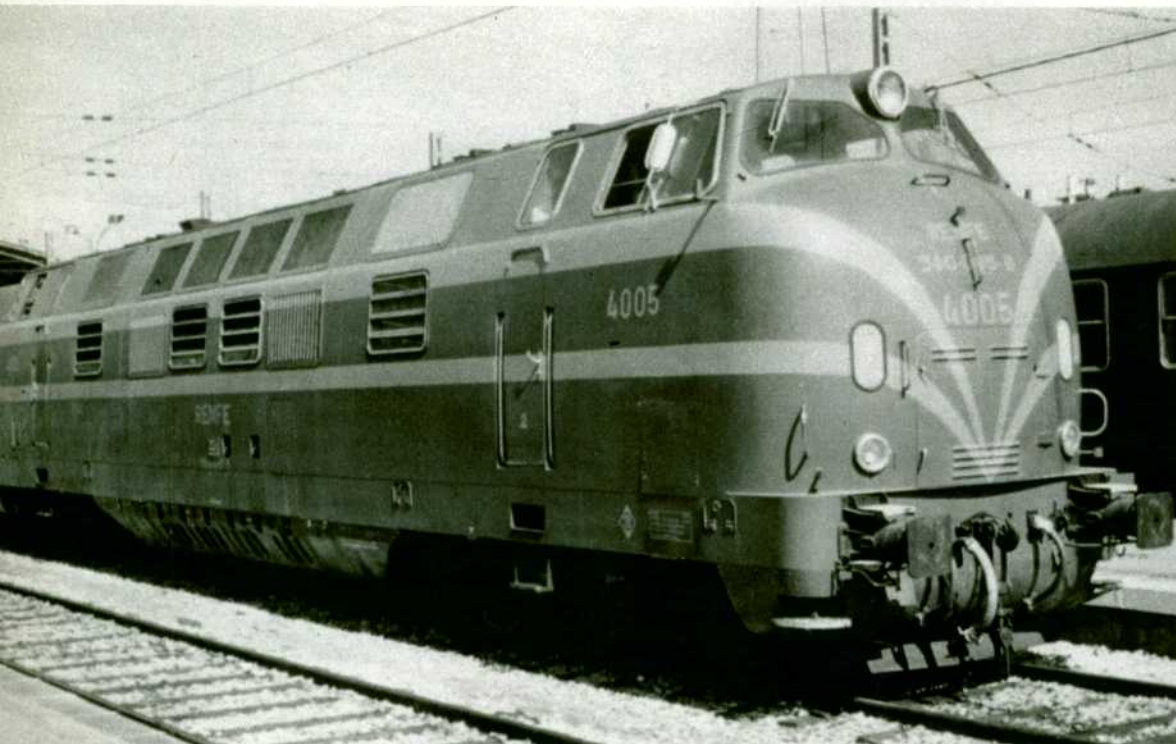
La 340 es la única serie de locomotoras Diesel de línea con tracción hidráulica.
