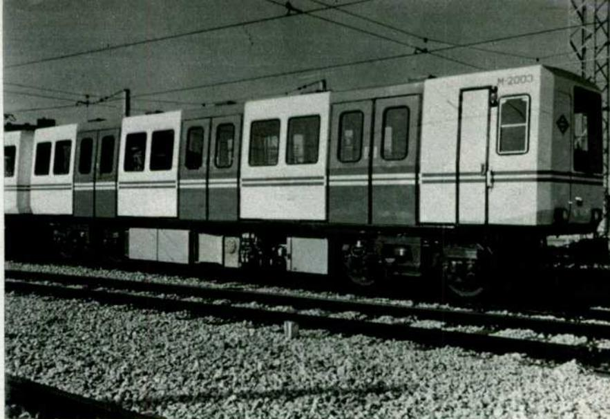
El diseño de las cajas de los coches trata de aprovechar al máximo el gálibo estrecho de túneles y estaciones.
