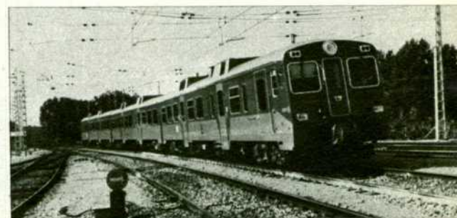
Automotor 3423 Valencia-Cuenca-Madrid, realizado con un 592 de Valencia. Los 592 y 593 se distinguen fácilmente por el techo inclinado en el testero y el faro único.
