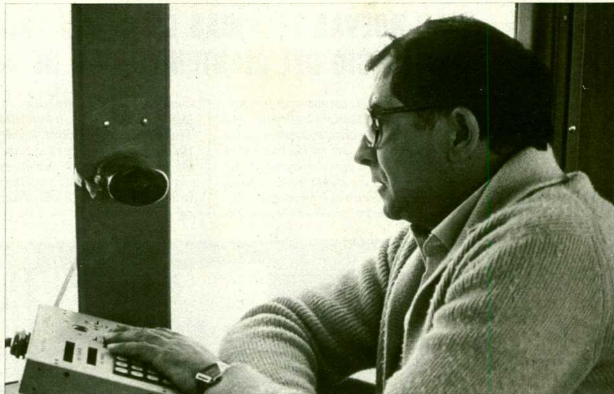
El dispositivo denominado "caja kilométrica" permite a un operador marcar en los registros algunas referencias físicas (puentes, túneles, estaciones) para facilitar la localización posterior de los defectos sobre la vía.
