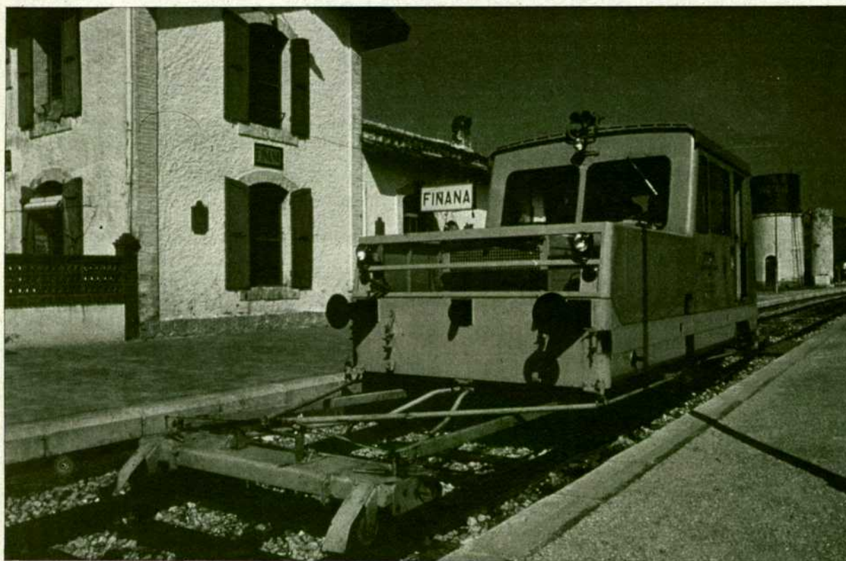
Las dresinas geométricas fueron el antecedente inmediato de los modernos vehículos de control. Toda la transmisión de las medidas era en ellos totalmente mecánica.
