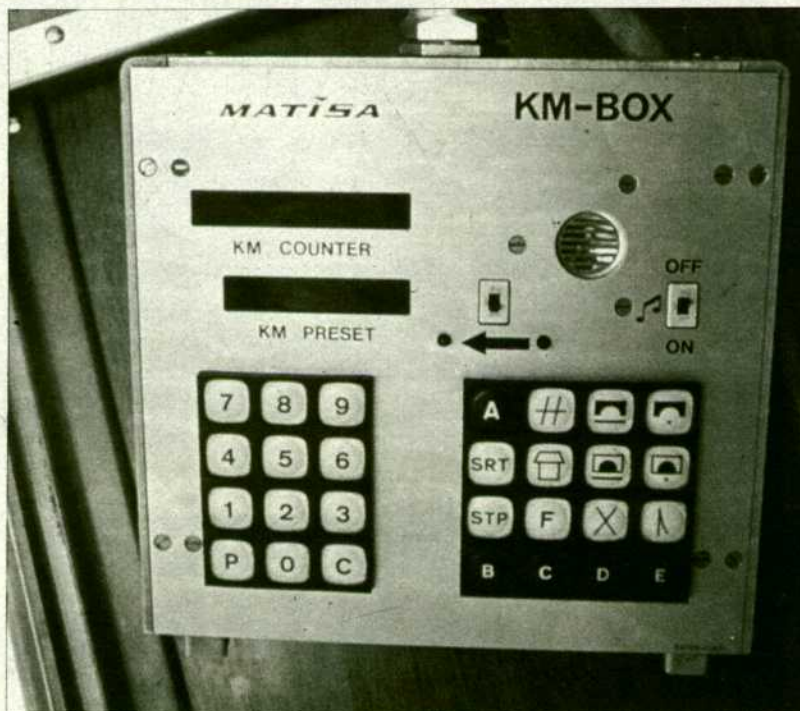
El dispositivo denominado "caja kilométrica" permite a un operador marcar en los registros algunas referencias físicas (puentes, túneles, estaciones) para facilitar la localización posterior de los defectos sobre la vía.
