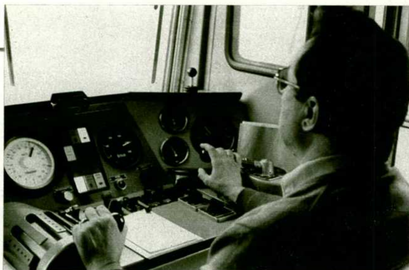
Pupitre funcional de los nuevos automotores 593, cuya conducción es delicada en las fuertes rampas de Almería a Linares-Baeza.
