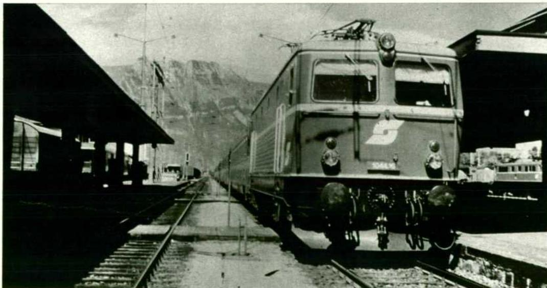
El Transalpin es remolcado de Busch a Viena por la más moderna locomotora de los OBB, la 1044, con 7.300 CV. y regulación por Chopper.
