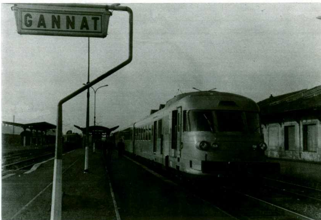
Los turbotrenes RTG tienen dos coches motores y tres remolques intermedios.
