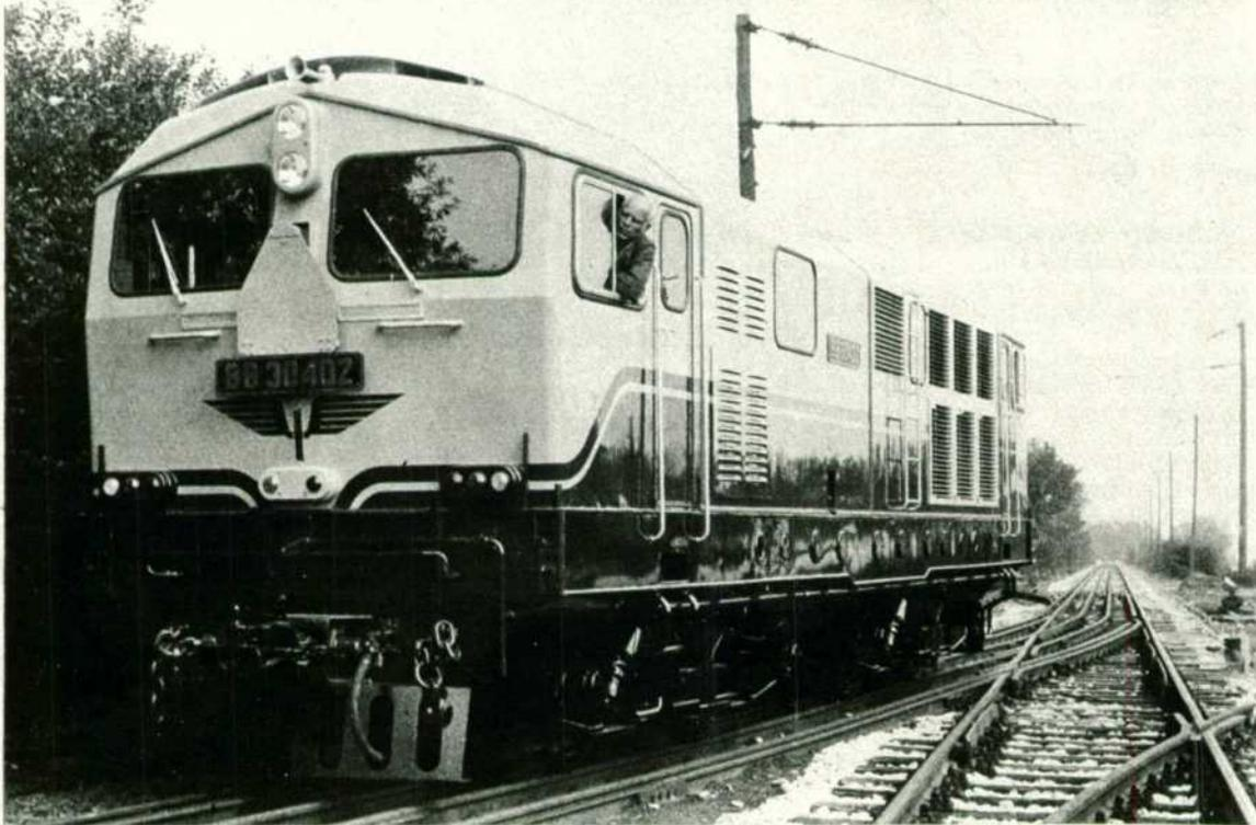
Los ferrocarriles estatales de Indonesia, PJKA, han encargado a Krupp once nuevas locomotoras de la serie BB 304, con 1.104 kilovatios (1.500 CV.) y 1.067 milímetros de ancho de vía. El 64 por 100 del parque de máquinas indonesio proviene de la misma empresa.
