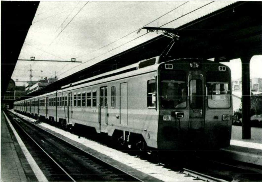
que intermedio y remolque con cabina. La numeración asignada a cada uno de estos tres coches que constituyen una unidad es 440-000, precedidos respectivamente en cada caso por el dígito 9, 7 u 8. Así, por ejemplo, la numeración del coche motor será 9-440-000 y la del remolque con cabina 8-440-000. Como es sabido, los tres últimos dígitos (000) constituyen el número de orden (001, 002, etcétera) del vehículo dentro de esta serie 440.
