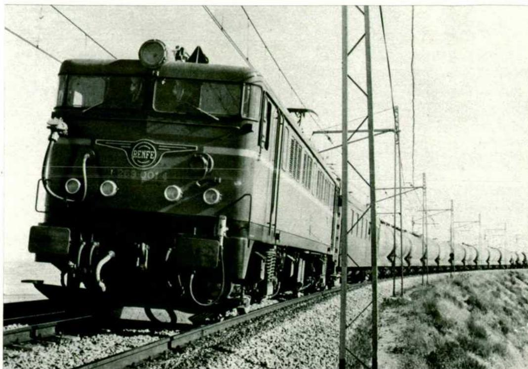
motora dispone de seis motores. Los motores están suspendidos por la nariz y la transmisión del movimiento se realiza a través de un reductor tradicional. El bogie dispone del típico pivote para cumplir las funciones de guiado de la caja y la transmisión de los esfuerzos de tracción y frenado. La base rígida del bogie es de 4.000 mm.
